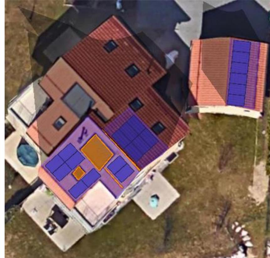
Attention : Pour les installations sur des annexes (type garage), il est préférable qu'une gaine électrique soit en attente pour le tirage des câbles entre la villa et l'annexe
